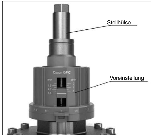
Abb. 2 Stellhülse (vor Veränderung der Voreinstellung abschrauben)
